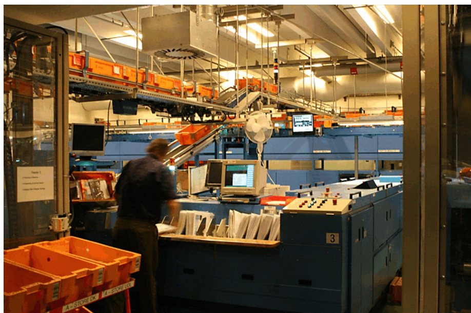
Gott om plats. Inmatningen (en av fyra) vid Köpenhamnsterminalens SSM. Terminalen har tre SSM:ar, tillverkade av NEC.
